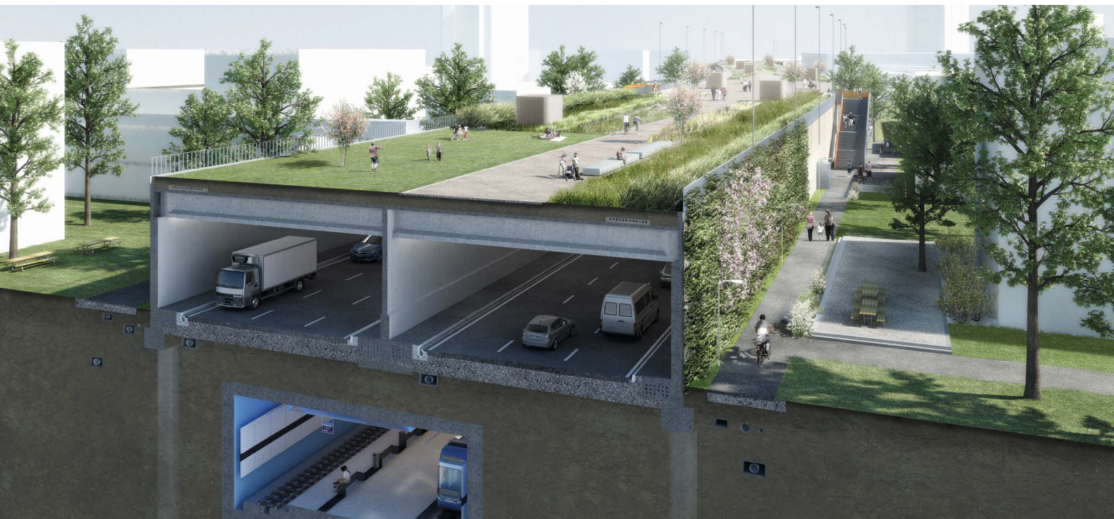
Nutzung auf drei Ebenen: Trambetrieb, Autobahn und Ueberlandpark (Bild ASTRA Infrastrukturfiliale Winterthur)
